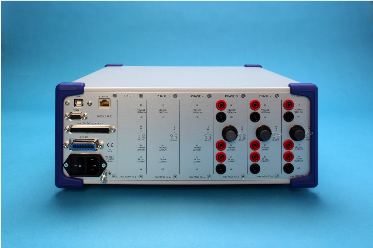
Abbildung 1.5 Rückwand eines dreiphasigen Leistungsmessgeräts
